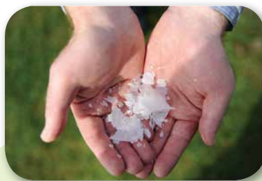
15. ábra: Fragmentált oxo-degradálható polimer anyagok (Loughborough University 2010).
